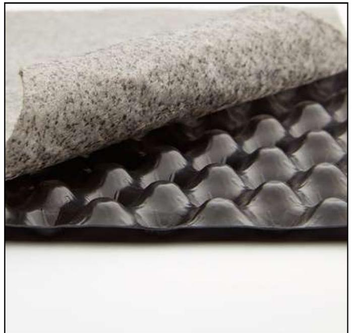
La **nappe drainante** a une épaisseur de 6mm pour une largeur de 0,55m. Elle se compose d'une structure alvéolaire en PEHD, enrobée par un géotextile.
