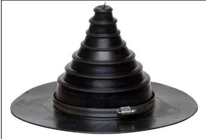
Le **QuickSeam Pipe Flashing** sert à étancher des pénétrations de sections circulaires rigides, d'un diamètre compris entre  $\varnothing 25\text{mm}$  et  $\varnothing 152\text{mm}$ . Ces pénétrations doivent se trouver au-dessus de l'eau et sur une surface plane.
