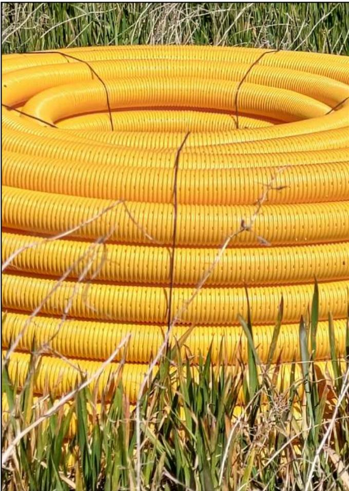
Le **drain PVC** est de couleur jaune et, de par sa conception, il est très flexible. Ce sont des drains perforés permettant d'évacuer l'eau présente dans le sol.
